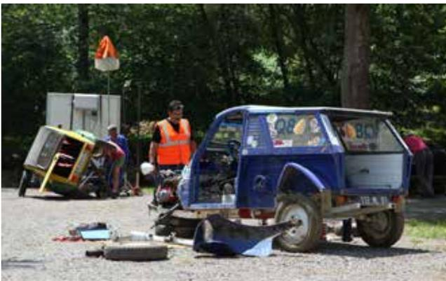
Au premier plan, Peyo suit le remplacement du train avant dont le support est brisé. Derrière, soudure du support de pot de suspension droit arraché sur la voiture aux couleurs du Brésil.
