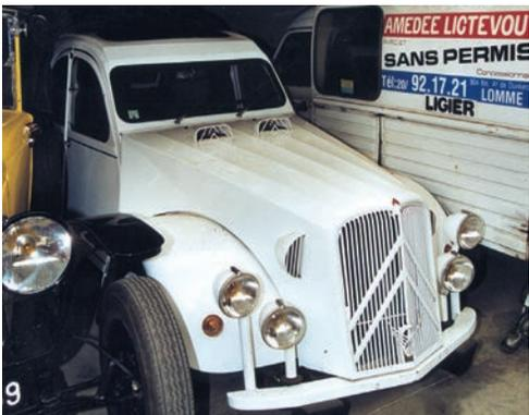
La 2 CV diesel a un capot rallongé pour laisser la place à la mécanique qu'elle emprunte à la Visa. Elle est personnalisée dans un style proche de celui de la Traction. On trouve dans cette voiture réalisée avec six voitures différentes : des freins assistés, 4 roues indépendantes, la suspension hydropneumatique, des phares tournants... 1 000 heures de travail durant trois ans ont été nécessaires pour la transformer ainsi avec l'aide de son fils.
