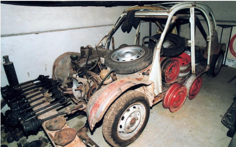
Pas encore terminée, cette caisse de 2 CV est greffée sur une plate-forme de GS 4x4 à compresseur développant 100 ch.
