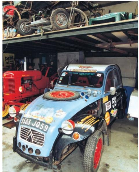
La 2 CV à double boîte de vitesses avec laquelle Amédée a fait le dernier Raid des Baroudeurs en Tunisie (voir *Planète 2 CV* n° 42). Le toit blanc est en tôle, car visiblement Amédée n'aime pas le sable à l'intérieur. Le capot se soulève laissant la roue de secours sur un dispositif fixé au châssis. En cas de besoin, les roues peuvent être jumelées à une paire d'autres roues par un système d'attaches spécial.
