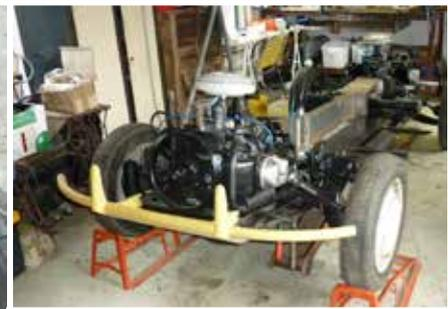
Le châssis, ses mécaniques et les tunnels de transmission.
