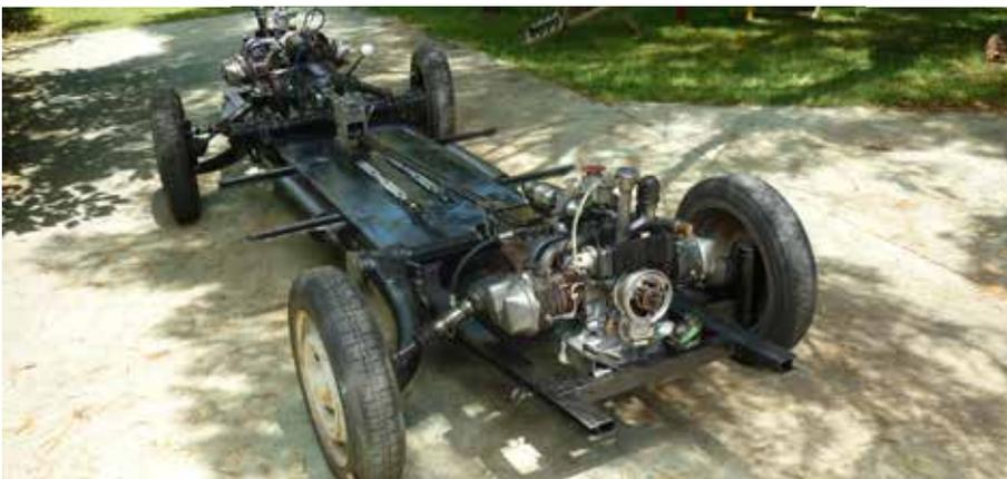
Les mécaniques, deux moteurs de chacun 425 cm<sup>3</sup> de 12 ch maximum, complètent le châssis et les essieux restaurés. Nous regardons ici l'arrière de la voiture (pas facile de faire la différence entre les deux extrémités en l'absence de la carrosserie).
