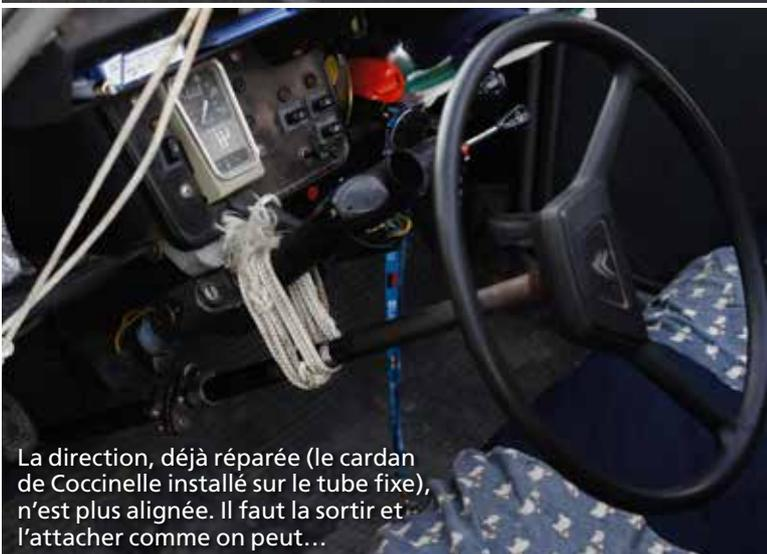
La direction, déjà réparée (le cardan de Coccinelle installé sur le tube fixe), n'est plus alignée. Il faut la sortir et l'attacher comme on peut...
